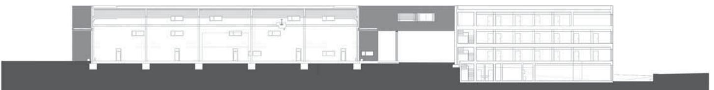
Schnitt: Der an die repräsentative Wartungs- und Montagehalle angegliederte Bürotrakt aus Containern wurde planerisch bereits beim Bau auf Erweiterbarkeit ausgerichtet. Der Neubau mit 24 Einheiten auf drei Geschossen integriert sich harmonisch und ohne funktionelle Einbußen in das Ensemble.
